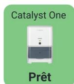
Une icône verte **Prêt** indique que l'analyseur est connecté et communique avec l'IDEXX VetLab Station.
